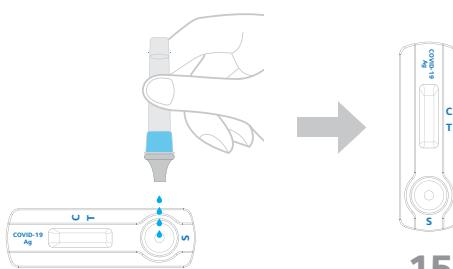
Položte kazetu na rovný povrch, označte ji a přidejte 4 kapky testovaného vzorku do jamky na vzorek. Výsledky budou připraveny za 15 minut.
